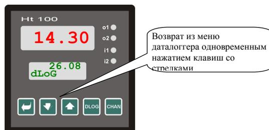
Периодичность архивирования измеренных значений установите на *уровне обслуживания* - параметр **Dtper**, условия записи в даталоггер установите в параметре **DtSto**.
