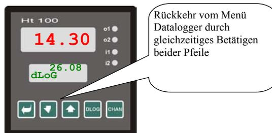
Die Periode für die Archivierung der Messwerte wird in der **Bedienungsebene**, Parameter **Dtper**, eingestellt, die Bedingung für das Einlesen in den Datalogger wird im Parameter **Dtsto** eingestellt. Der Zugriff auf beide Parameter erfolgt über die **Benutzerebene**.
